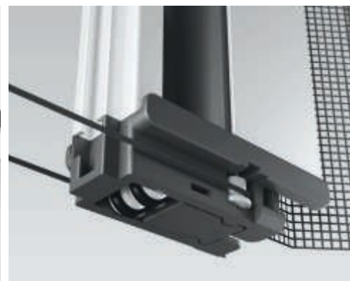
Две странични ролки отдясно и отляво, и долно направляващо колело със силиконови вложки.
